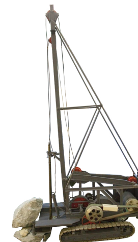
05_Станок канатно-ударного бурения глубоких скважин /1200x550x2500/
